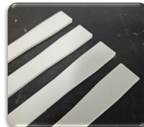
Aspect Visuel des échantillons de PLA imprimés au cours du troisième cycle de recyclage
